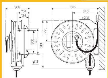
**Avvolgitubo modello BG senza tubo / Hose reels model BG without hose**
