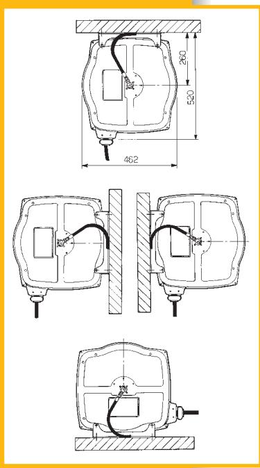
**Avvolgitubo modello MC senza tubo / Hose reels model MC without hose**
